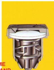
Chaque bouchon est constitué d'un labyrinthe spécial avec membrane en PTFE (Polytétrafluoréthylène) empêchant les débordements d'acide. Grâce à son couvercle STS, la batterie Fulmen Prestige a satisfait au test du "roll over"\*\*.
