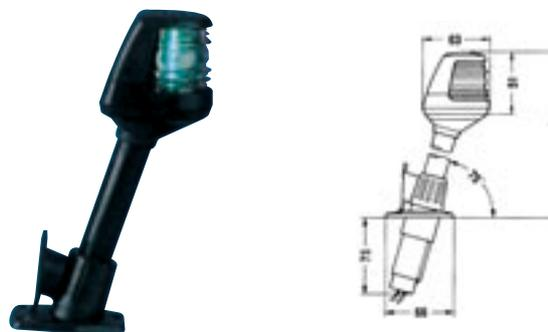
Feu télescopique. Tout horizon 360°. Mât incliné de 15° à prise intégrée. Se fiche comme une prise de courant. Le feu étant démonté (pour éviter le vol ou pour le transport), la prise encastrée est protégée par un bouchon étanche. Ampoule halogène 12 V - 5 W BA9S (fournie).
