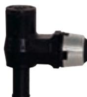
Coudé plastique, couvercle inox. Étanche, empêche l'entrée d'eau dans le réservoir. Plus besoin de boucle anti-siphon sur le tuyau d'évent. Pour tuyau Ø int. : 16 mm. Hauteur nécessaire : 38 mm.
