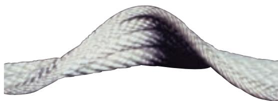
Tresse blanche hélicoidale "HELI" en polyester, densité 1,38 multifilaments haute ténacité, 12 fuseaux.
