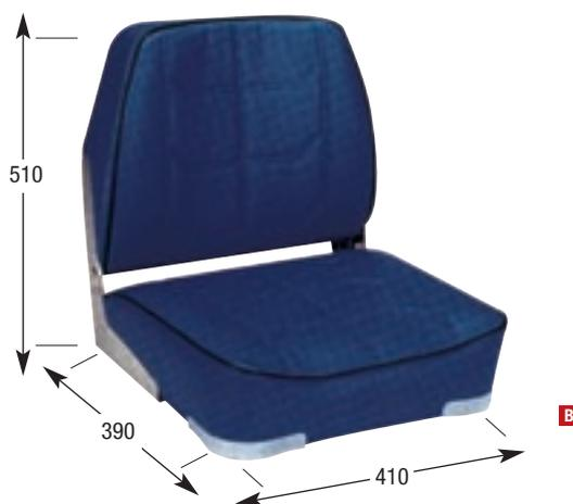
Cadre plastique et contreplaqué marine. Coussins en mousse recouvert de vinyle résistant, articulations alu avec platine de rotation 360°. Entraxe de fixation 135 mm. Support pivot non fourni - Epaisseur plié 230 mm.
