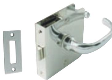
Serrure laiton chromé gâche inox et plaque inox, carré 8 mm. Encastré : 44 x 58 x 15 mm. Apparent : 80 x 70 x 18 mm.
