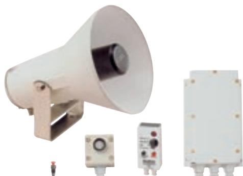
Appareil de signalisation sonore conforme au règlement anti-collision iMo 72 règle 33 - Pour bateaux de 12 à 20 m. Sifflet polyester renforcé fibre de verre. Ø 236 x lg 302 mm (3,5 kg). Générateur tôle d'acier revêtement plastifié blanc. 226 x 134 x H 73 mm (1,5 kg). Fréquence de base 630 Hz. Niveau de pression acoustique 120 dB/tiers/1 m. Impédance de la trompe : 8 Ohms.
