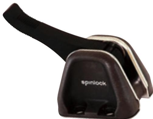
Coinceur manuel compact et économique. Il convient aux drisses des petits voiliers de croisière jusqu'à 25 pieds (8 m). Ce type de coinqueur à came doit être engagé manuellement et la charge reprise sur un winch avant ouverture (ce n'est pas un bloqueur). Libérable sans reprendre la charge sur le winch. Permet de gagner de la place sur le pont et regroupe les cordages (Ø 8-10 mm).
