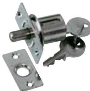
Serrure laiton nickelé satiné à bouton poussoir, pour porte d'ép. 20 mm. Cylindre Ø : 18,6 mm. lg : 25 mm. Plaque 40,5 x 20 mm. Bouton Ø 8 mm. Entraxe de perçage : 30 mm.
