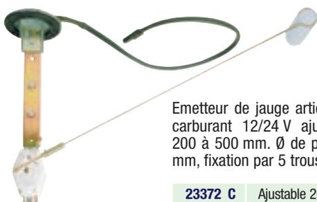
Emetteur de jauge articulée pour carburant 12/24 V ajustable de 200 à 500 mm. Ø de perçage 42 mm, fixation par 5 trous.
