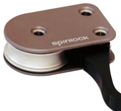
Poulie plat pont avec coinqueur, empilable et réversible. A came manuelle. Cette poulie simple et compacte convient pour de nombreuses applications. Engagement et largage manuel; il n'y a pas de ressort, sauf Ø 63 & 75 mm (comme pour les poulies plus importantes, le largage manuel n'est possible que sous faible charge). Parfait pour le contrôle des bosses de ris, des chariots ou des bouts d'enrouleurs sur les petites unités.
