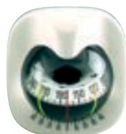
Série 95 : Compas sur cloison, rose apparente Ø 95 mm cône. Eclairage par LED lumineuses. Inclinaison jusqu'à 45°. Pour bateaux de 5 à 9 mètres.
