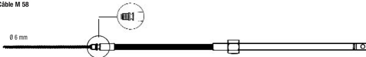
Pour boîtier de direction : Ultraflex T67. Morse C0230 - 231 (après 01/95). TFX : compact-T, 805 TX (Si votre boîtier de direction est antérieur à Janvier 1995, utilisez l'adaptateur 23255G (K55) avec le câble M58).
