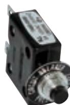
Disjoncteur thermique à réenclenchement manuel. Fixation Ø 10 mm. Lg 35 x 45 x ep. 6 mm. Raccordement clips mâle 6,35 mm. Certification UL.
