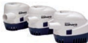
Nouvelle gamme de pompe de cale automatique (avec contacteur incorporé) type "SAHARA". Moteur à aimant permanent, câble électrique d'une longueur de 90 cm traité à l'étain pour éviter toute corrosion. Axe inox. Encombrement identique pour tous les modèles. Contacteur interne équipé d'une commande manuelle externe pour contrôle du bon fonctionnement de la pompe.
