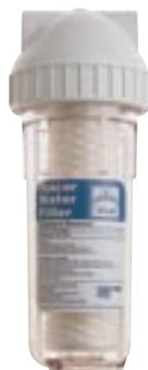
Sépare et filtre les impuretés du circuit d'eau douce du bord. Dim. : Lg : 318 mm - Ø : 133 mm - Poids : 1,4 kg - Raccord entrée sortie 3/4" NPT ( non fourni ). Utilisable pour une eau à 38°maxi. Débit max 23 litres/mn.
