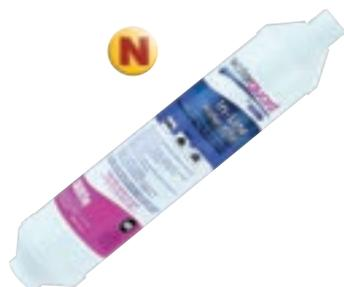
Filtre en ligne au charbon de noix de coco lavé par eau. Sous l'évier ou comme filtre de machine à glaçons. Longue durée, élimine les odeurs et les mauvais goûts tout en réduisant la tenue en chlore. Entrée/sortie cannelées Ø : 1/2" ( 13 mm ). Dim. : Lg : 279 mm - Ø : 64 mm. Pression max : 8 bars. Durée : 27000 litres environ.
