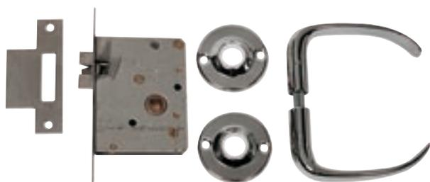
Serrure + gâche inox, carré 9 mm. Têtière 144 x 18 mm. Encastré pr. 73 x ht 95 x ép. 11 mm. Pêne anti-vibrations, 2 poignées laiton chromé lg 102 mm, 2 rosaces laiton chromé Ø 60 mm + bague nylon.
