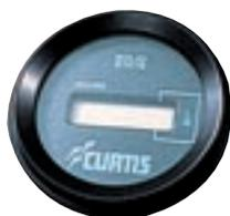
CURTIS 12/24 V à cristaux liquides. Ø 52 mm, étanche, le sablier clignote quand l'appareil fonctionne. Branchements : borne 1 : + batterie, borne 2 : - batterie, borne 3 : + contact.
