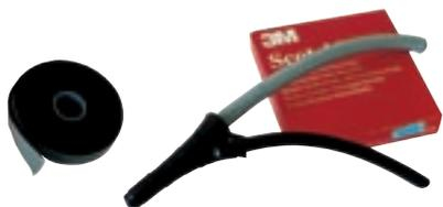
Isolant autovulcanisant se transformant, après application, en une masse homogène. Allongement à la rupture 1100 %. 9,15 m x 19 mm.
