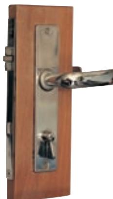
Serrure + gâche inox Carré poignées 9 mm, carré condamnation 7 mm. Têtière 212 x 18 mm. Encastré pr 72 x H 164 x ép. 12 mm. 2 poignées laiton chromé Lg 106 mm. 2 plaques de propreté laiton chromé 196 x 38 mm + bague nylon
