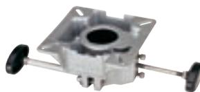
Platine pivotante 360°, pour tube Ø : 73 mm. Double verrouillage montée / descente et rotation. Entraxe : 125-140 mm.
