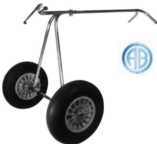
Chariot avant permettant la manutention sans effort de tout bateau pneumatique. Tube rond acier inox 316 L. Roues gonflables Ø 400 mm. Chariot entièrement démontable. Faible encombrement, loge dans un coffre de voiture (s'utilise avec roues de halage à l'arrière).
