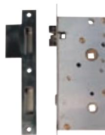
Serrure gâche inox anti-vibrations, 2 clés, carré 8/7 mm. Encastré : 163 x 73 x 13 mm. Têtière : 212 x 18 mm. Entraxe : 75 mm.
