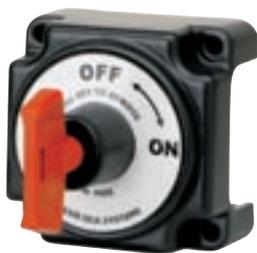
Le coupleur de batterie permet d'isoler ou, au contraire, de coupler les circuits de servitude et de démarrage du moteur. Se pose de préférence sur le circuit côté utilisation (+). La tension d'utilisation maximale de ces coupleurs est de 32 V.
