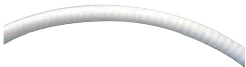
Tuyau PVC blanc (non translucide) plastifié, renforcé d'une spirale en acier. Température d'utilisation -15° à +60°. Convient parfaitement pour le passage de la plupart des eaux usées et d'autres liquides (sauf huiles).
