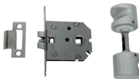
Serrure laiton chromé gâche inox, carré 8 mm. Têtière 110 x 15 mm, ovalisé. Encastré pr. 68 x ht 60 x ép. 13 mm. Pêne anti-vibrations. 2 poignées, bouton Ø 40 x ht 32 mm + encoche doigt + bagues nylon.
