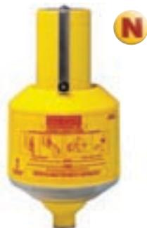
Permet de lancer une amarre à une distance de 250 à 300 m suivant modèle, se compose d'un corps cylindrique en plastique avec poignée, d'une fusée, d'un percuteur et d'une ligne d'amarrage de 275 à 300 mètres. Poids 3,9 Kg. Conforme SOLAS 74.83 et 74.96, Marine Marchande France.
