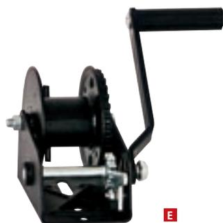
Son axe Ø 51 mm permet au câble du filet de s'enrouler sans à-coups. Les goupilles soudées à l'axe permettent d'attacher le câble. Pignon forgé 1 pièce. Roulements lubrifiés - 2,4 kg (spécifications tableau ci-dessus).
