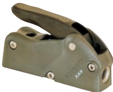
Bloqueur XAS 0612. Nouveau bloqueur modulaire, résistant et facile à utiliser. Remplace la gamme XA, dont il conserve les entraxes. Pour les croiseurs jusqu'à 35' et les voiliers de régates jusqu'à 27'. Cordage Ø 6-12 mm.
