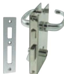
Serrure laiton chromé gâche inox, plaque inox, condamnation intérieure, disque blanc / rouge, carré 8 mm. Encastré : 95 x 58 x 15 mm. Apparent : 133 x 70 x 15 mm.
