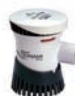
Nouvelle gamme de pompes de cale type "TSUNAMI" de ATTWOOD garanties 3 ans. Double fixation moteur et plaque support par enclenchement 1/4 de tour. Ensemble pompe-moteur pouvant être interchangeable avec les pompes aérateurs Tsunami de même puissance. Axe inox. Encombrement identique pour tous les modèles. Moteur à aimant permanent, câble électrique d'une longueur de 90 cm traité à l'étain pour éviter toute corrosion.
