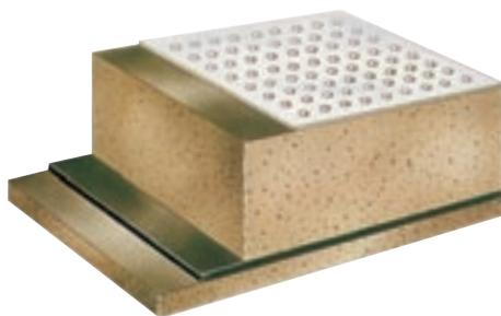
Mousse Insonorisante. Constituée de 2 plaques de mousse de 5 et 25 mm d'épaisseur, entre lesquelles est interposée une plaque anti-réverbération de 4 mm. La mousse absorbe le bruit et la plaque arrête les vibrations. Finition vinylique blanche perforée. Auto-extinguible. Conserve ses propriétés de -10° à +90°C
