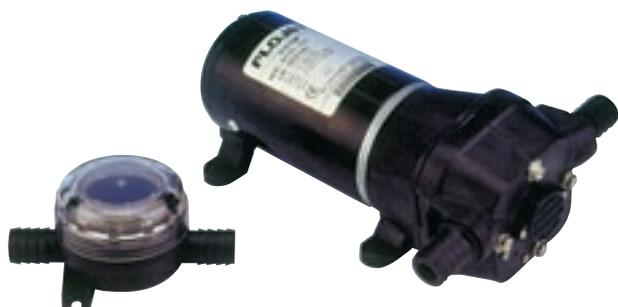
Auto amorçante jusqu'à 3 mètres, peut tourner à sec. Très silencieuse. Fournie avec filtre (16978B). Sorties pour tuyaux Ø 3/4" (fileté et cannelé). Débit de 19 l/mn. Poids : 2,8 kg. Dimensions : Lg 252 x H 95 x l 160 mm.
