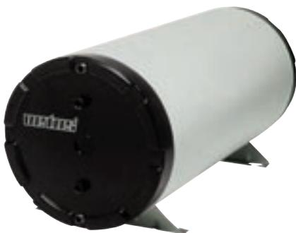
Le chauffe-eau Vétus peut-être installé horizontalement ou verticalement. La résistance électrique est en option, voir tableau des options ci-dessous. Le matériau isolant utilisé (mousse polyester épaisseur 35 mm) est si efficace que la perte de chaleur est limitée à 8°C par 24 h. Cuve interne inox AISI 304.
