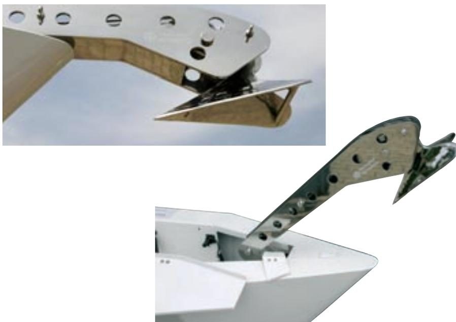
Le bureau d'études d'accastillage BERNARD, situé à Mandelieu, spécialisé dans la réalisation de projets sur mesure, innove en proposant un concept simple et ingénieux de davier basculant hydraulique : Grâce à son système hydraulique, le davier pivote sur 180° et vient se loger dans un coffre prévu à cet effet. Le pont est ainsi libéré, le mouillage disparaît, préservant les lignes du bateau.
