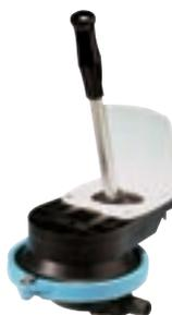
Pour montage à travers pont ou à travers cloison. 16 positions possibles des raccords par rapport au corps de pompe. Le desserrage d'une seule vis permet d'évacuer les débris et de replacer le corps de pompe dans n'importe quelle position (rotation de 360° par rapport à la poignée). Poignée de sécurité amovible inox. Membrane nitrile. Pompe avec poignée amovible, couvercle et kit passe-pont permettant 4 positions de montage différentes.
