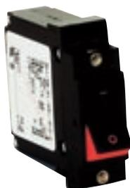
Disjoncteur unipolaire à encastrer. Pour tableaux PROS et autres montages. Fixations par deux vis en face avant. Entraxe 42 mm. 51 x 19 x pr. 51 mm.
