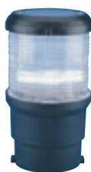
Feu 360° blanc à éclats (stroboscopique). 60 flashes/mn. Boîtier noir avec connexions sur socle rapide (Quicfits system). Utilisation réglementée par la navigation aérienne. Usage seulement en cas de détresse.
