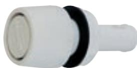
Polypropylène filtre. Inox 9/16". (Encastrement Ø : 22 mm). Pour tuyau Ø int. : 16 mm. Epaisseur de serrage : 15 mm maxi.
