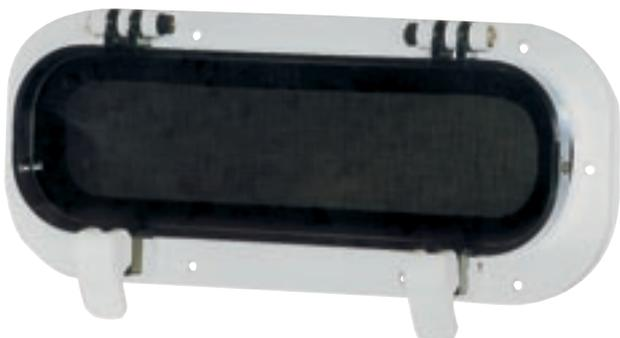
Hublot ouvrant "RAIN DRAIN" plastique blanc et plexiglass fumé. Avec système anti-obstruction des rainures pour évacuation complète de l'eau, jusqu'à une inclinaison de 45°. Pour une épaisseur de cloison maximum de 45 mm
