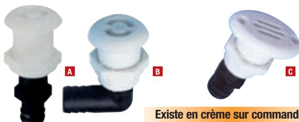
NUOVA RADE. Blanc. Pour tuyau Ø int. : 16 mm. Encastrable Ø : 29 mm. Epaisseur de serrage : 30 mm maxi.
