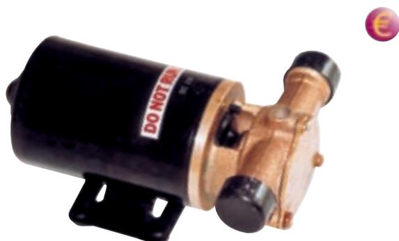
Pompe de cale et de transfert d'eau douce ou d'eau de mer à rotor souple, série économique - Ne peut pas fonctionner à sec - Auto-amorçante. Aspiration 1,50 m. Dimensions : 180 x 125 x 95 mm. Poids 2,46 kg. Corps bronze.
