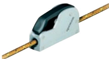
Bloqueur XCS. Caractéristiques identiques au XT, avec joues en aluminium. Recommandé pour les manœuvres devant être régulièrement larguées sous forte charge. Alu blanc pour bateaux de 12 m et plus. Cordage Ø 8-14 mm. Résistance 1200 kg.
