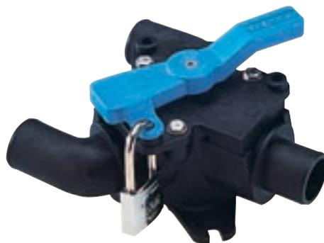
Permet d'évacuer les eaux usées par dessus bord ou dans un réservoir de rétention ou bien de vider deux sections de cale au moyen d'une pompe unique.
