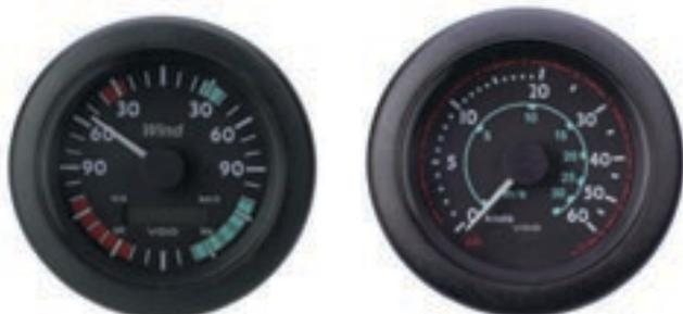
Cadran 12/24 V avec indication force du vent par afficheur LCD. Lecture de la direction du vent par aiguille. Emetteur aérien avec câble. Cadran complémentaire indicateur à aiguille force du vent, 12/24 V. Avec lecture Bft, m/s sur 3 échelles
