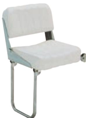
Pliable et rabattable. Articulations et pied inox 316. Le pied rabattable et réglable en hauteur de 400 à 560 mm peut être placé indifféremment à droite ou à gauche. Assise 400 x 400 mm. Dossier 400 x 200 mm.
