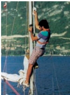
Permet de monter dans le mât sans risque et sans l'assistance d'un équipier sur le pont. Résistance : 650 kg. 2 poignées pour cordage de Ø 5 à 12 mm.
