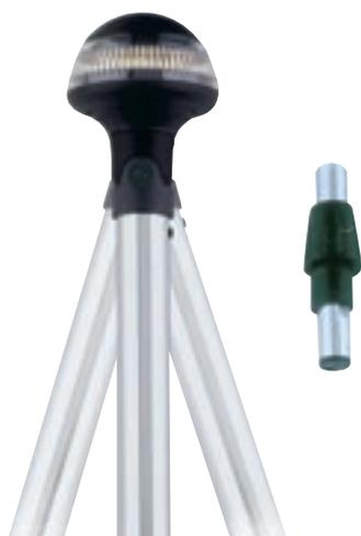
Pour bateaux jusqu'à 12 mètres. Feu tout horizon 360°, 12 V, 8 W. Hampe alu anodisé, pied universel. Base non fournie. Portée 2 milles. Amovible et articulé. Orientables de 15° vers l'avant ou vers l'arrière.
