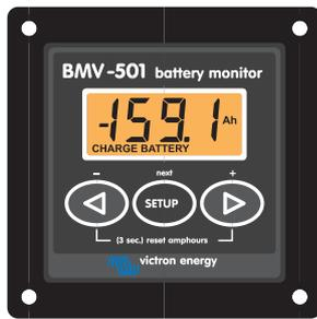
Le contrôleur de batterie BMV-501 affiche la tension, le courant, la consommation en ampère-heures, la capacité réelle ou l'autonomie restante. L'écran LCD rétro-éclairé assure une excellente lisibilité et une simple touche permet de sélectionner chacun des paramètres.
