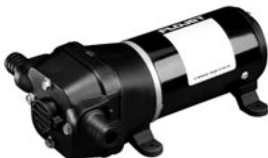
Auto-amorçante. Peut tourner à sec. Pour usage continu. Etanche aux projections d'eau et aux endroits fortement humides. Protection électrique interne en cas de température trop élevée avec redémarrage automatique.
