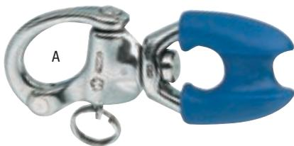
Mousqueton avec émerillon. Cosse surmoulée, polypropylène bleu + fibre de verre. Il permet l'épissure directe d'un bout sur la forme et supprime l'adjonction d'une cosse intermédiaire.
