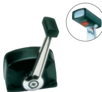
Boîtier en alliage injecté revêtu époxy noir mat, levier chromé. Commandes à double fonction (inverseur et accélérateur). Dispositif de sécurité permettant la manœuvre du levier d'inverseur uniquement lorsque le levier d'accélérateur est au minimum. Dispositif de commande avec ou sans trim.
