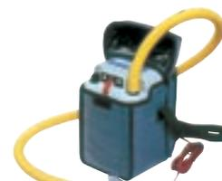
Gonfleur électrique "Bravo BST 12". Gonfle et dégonfle. S'arrête automatiquement à la pression voulue. Tuyau PVC 2cm. Connexions batterie avec pinces. 500 l./mm - 12V - 10A
