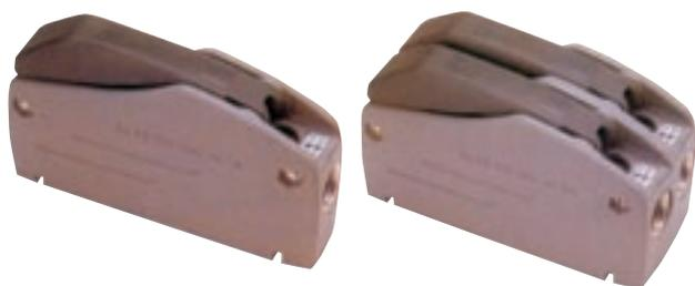
Utilisation sous charges élevées pour bateaux de 9,7 m (32 ft) maximum. Utilisation pour charges plus faibles et palans de réglage sur bateaux de taille supérieure. Pour cordages de 6 à 12 mm. Charge de travail sécurisée 500 kg.
