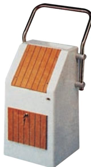
Pupitre de direction pour pneumatique en vitro-résine blanche et bois avec main-courante inox. Coffre à clé.
