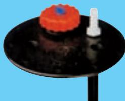
**9764 A** Plaque Ø75 mm porte accessoires pour réservoir d'eau avec bouchon Ø 46 mm intérieur. 1 sortie int. Ø 3/8". 2 sorties supplémentaires pré-perçées int. Ø 3/8". Raccords à prévoir.
