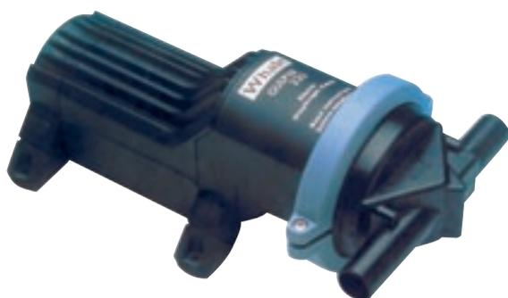
Auto-amorçante jusqu'à 3 m. Débit 14 l/mn. Poids 1,75 kg. Lg 273 x l 133 x H 117 mm. Corps en plastique - Sortie pour tuyaux Ø 19 mm.
