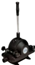
Montage sur pont ou à travers pont (avec kit passe-pont et étrier optionnel). Corps en alliage léger, robuste et tout particulièrement adapté aux utilisations professionnelles et de sauvetage. Double diaphragme nitrile, permettant à chaque côté de la pompe de fonctionner indépendamment. Poignée haute résistance de 45 cm. Membrane nitrile.
