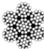
Câble 7 + 19 (soit (6 + 1) 1 toron (1 + 6 + 12) fils) : très souple, capable d'encaisser des torsions importantes (câble de drisse, drosses de gouvernail, bastaques...) recommandé pour les câbles en mouvement passant dans des réas de poulie. Câblage croisé, préformé à droite. Conditionné en rouleau de 100 m.
