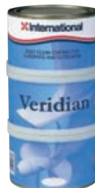
Sans biocide, il limite l'adhérence des salissures sur les embases et hélices aluminium. Sa surface anti-adhérente est facile à nettoyer (une simple éponge douce suffit) et un système intact peut durer plusieurs années. Veridian s'applique également sur un ancien antifouling en bon état. Veridian est un système bi-couche qui se compose d'une couche de liaison (tie-coat) et d'une couche de finition (top-coat).
