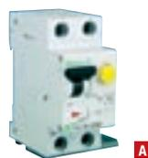
Disjoncteur différentiel 30 mA. Homologué NFC 61420. 1 pôle protégé + neutre, encastré, connexions pour câble 16 mm<sup>2</sup> maxi. Fixation sur rail 27435 G. Dimensions : 90 x 35 x 70 mm. Protection des personnes.
