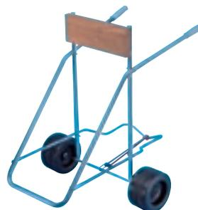
Support moteur acier zingué avec base porte-réservoir. Livré avec sandow pour fixation. Hauteur : 90 cm. Roues spéciales pour sable  $\varnothing$  : 220 mm. 20 CV (14,72 kW) maxi.
