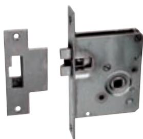
Serrure + gâche inox anti-vibrations, carré 9 mm. Encastré : 95 x 73 x 13 mm. Têtière : 144 x 18 mm.
