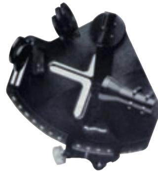
ANTARES - Tambour micrométrique gradué en minutes. Crémaillère usinée, vis sans fin débrayable. Limbe graduée en chiffres blancs de -20 à +120 degrés. Petit et grand miroirs réglables. 5 écrans colorés. Lunette de grossissement x 3. Livré avec clé de réglage dans un coffret en plastique.
