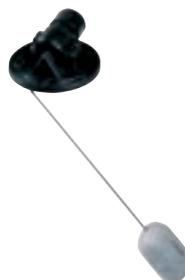
Emetteur Jauge 12/24 V niveaux eaux grises et noires. Elle donne uniquement le niveau entre la partie supérieure du réservoir (plein/full) et environ 16 cm en-dessous de la partie supérieure du réservoir (vide/empty). Ø de perçage 42 mm, fixation par 5 trous.
