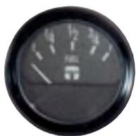
Récepteur de niveau carburant 12 V. Ø encastrement 51 mm, lunette Ø 56 mm. Fond noir, graduation et aiguille blanche.
