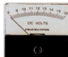
Voltmètre 8-16 V à échelle dilatée pour un meilleur contrôle de la batterie. Ø d'encastrement 52,5 mm, profondeur 24 mm, dimensions du cadran extérieur 71 x 61 mm, consommation 1 mA, précision 3 %. Graduations noires sur fond blanc, corps noir.
